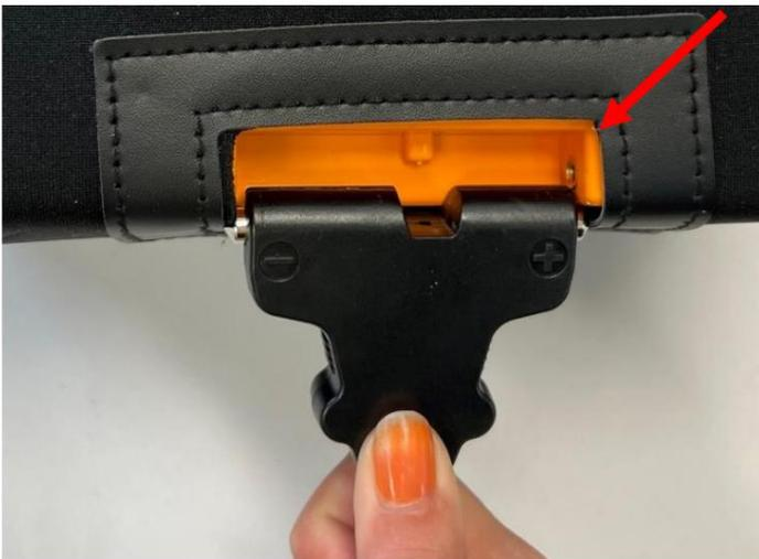
La prise de charge se trouve sur le côté droit de la batterie, sous le rabat velcro. Lorsque vous branchez le chargeur sur le secteur, un voyant vert s'allume. Lorsqu'il est branché sur la batterie, il devient rouge. Une fois la charge terminée, le voyant devient vert.
