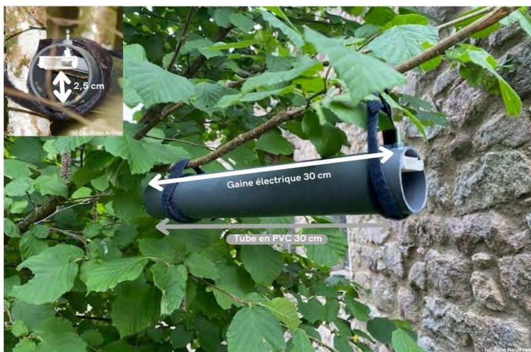
Illustration 4 : Positionnement et schéma d'un tunnel à poils © Christian Arthur et Julie Noulhiane
