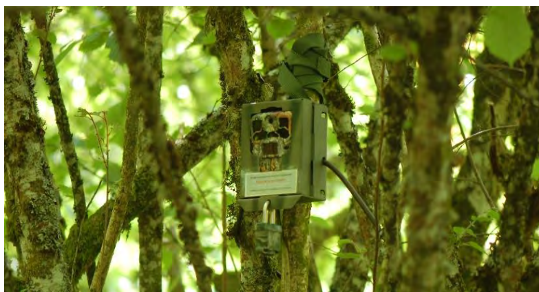
Illustration 7 : Appareil photographique utilisé et modalité de pose par la SFPEM dans l'étude
